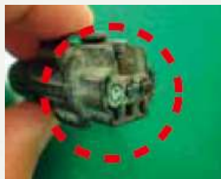
配線・カプラ錆・腐食
